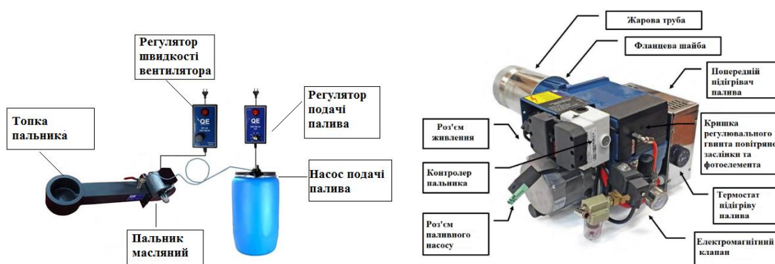
Рис.2в Будова комплекту масляного пальника до котла «Retra-3М»
